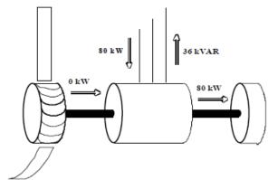
La puissance absorbée au réseau est donc de 80 kW
