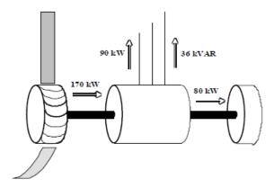
La puissance fournit au réseau est donc de 170-80=90kW
