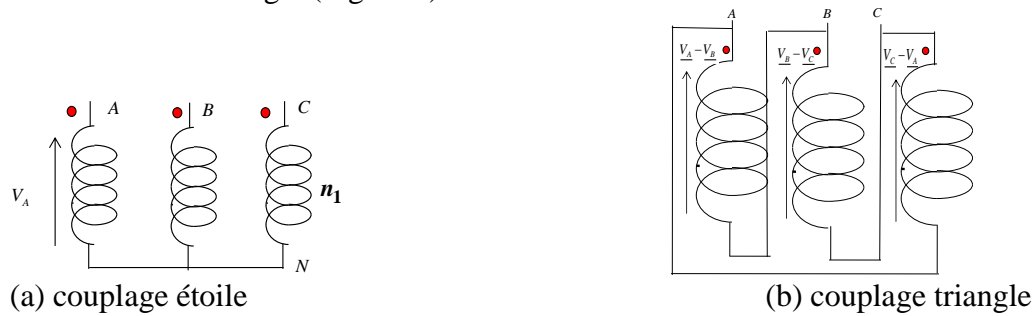
Figure 2 – Différents couplages du primaire
